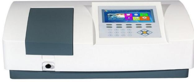
شكل رقم (2) جهاز قياس الطيف الضوئي (spectrophotometer)
